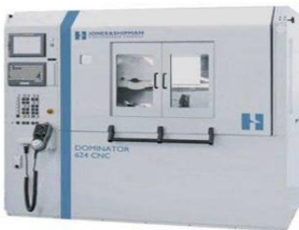
2.4.1 pav. Plokščiojo šlifavimo staklės Dominator 624 (gamintojas Jones & Shipman)
