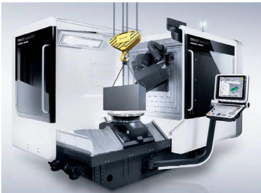
23 pav. DMU duoBlock staklių ruošinio apdėjimas ant darbinio stalo.
