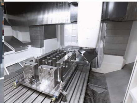
39 pav. Staklės DMU 600: pagreitis 3 \text{ m/s}^2 , tikslumas 15 \mu\text{m} , standumas atitinką standrtą GSJ-500-7 / 600-3
