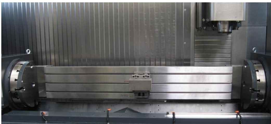
24 pav. Paverčiamas stalas (vietoj stacionaraus stalo) bei vartoma frezavimo galva
