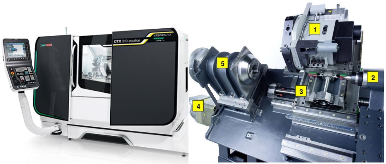
4 pav. Tekinimo staklės CTX: 1 – 12 įrankių dėtuvė (6 aktyvūs įrankiai); 2 – automatinis atraminis centras; 3 – kreipenčiosios; 4 – dinamiškas suklio variklis; 5 – suklys;
