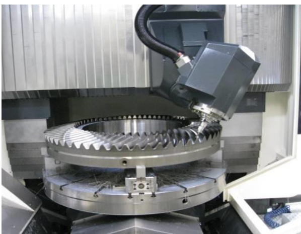
36 pav. Besisukanti ir paverčiama krovimo stotis
