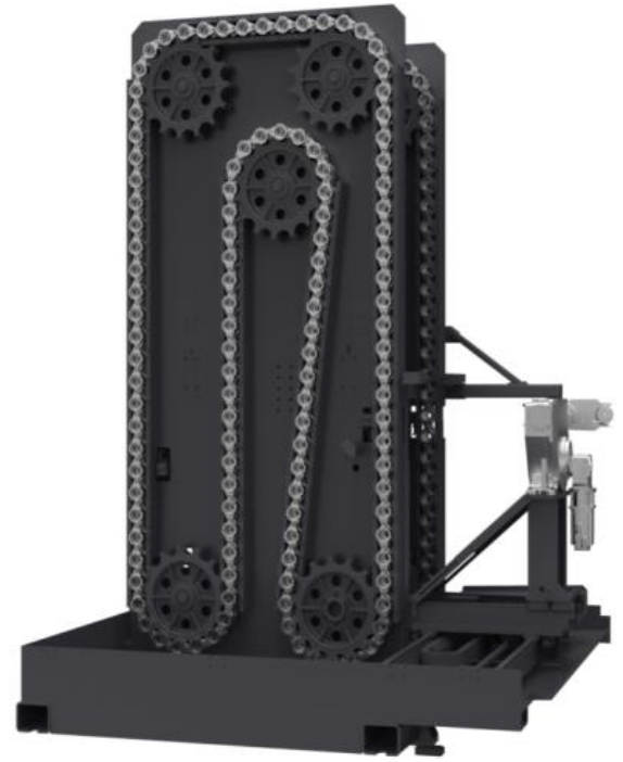
28 pav. DMC H horizontalių staklių įrankių sandėliavimo grandininė sistema.
