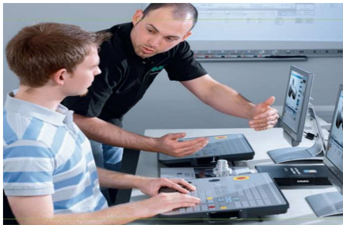
7 pav. Tekimo staklių operatoriaus valdymo pultas bei analogiška programa kompiuterio ekrane kaip realių-turimų staklių valdymo pulte.
