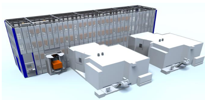
30 pav. Automatizuota palečių saugykla su dviem integruotom horizontalaus frezavimo staklėmis.
