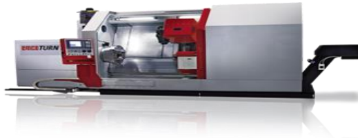
2.2.3 pav. Emco turn 900: skersinis judesys (X) 400 mm, išilginis judesys (Z) 1000 – 2000 mm, suklinė galvutė 40/60 kW, įrankių pavara 8 kW, greita eiga X/Z 10 m/min.
