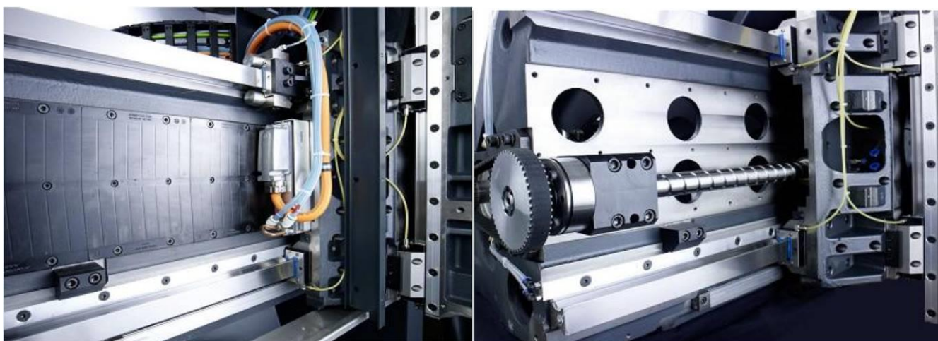
19 pav. Linijinis variklis (kairėje) ir įprastas elektros variklis su sraigtais (dešinėje).
