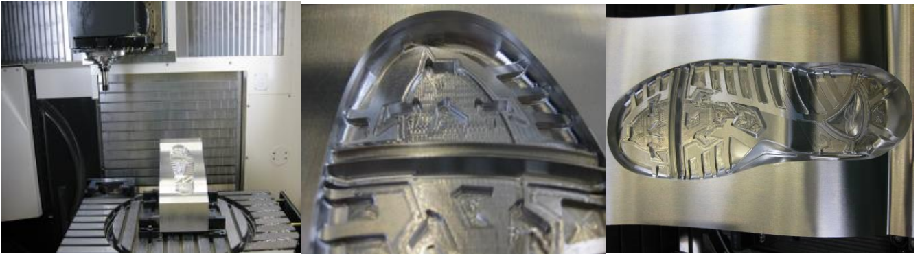
13 pav. Pado forma: Aliuminis (Formadal 23), 1 pastatymas, 18000 aps/min, paviršiaus šiurkštumas Ra 0.6, kontūro tikslumas 0.03 mm, panaudoti 9 įrankiai, apdirbimo laikas 345 min.
