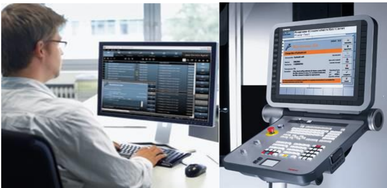
8 pav. „Staklių aptarnavimo agentas“ – programos aplinka kompiuteryje (kairėje) ir pranešimas operatoriaus valdymo pulte (dešinėje)
