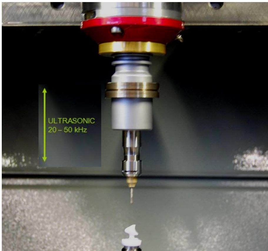
43 pav. Ultrasonic technologija įrankio laikiklyje sukelia virpesius 20-50 kHz įrankyje darbo metu.
