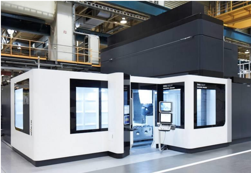
39 pav. Staklės DMU 600: pagreitis 3 \text{ m/s}^2 , tikslumas 15 \mu\text{m} , standumas atitinką standrtą GSJ-500-7 / 600-3
