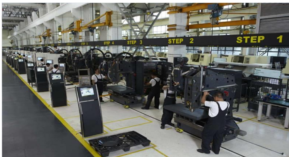
10 pav. Frezavimo staklių surinkimo linija Šanchajuje.
